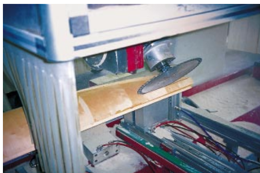
CNC-Bearbeitung des Treppenauges
